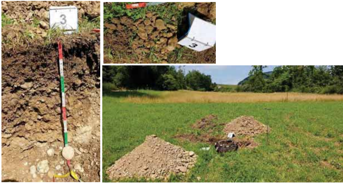
Foto 3: Profil Nr. 3 mit Profilwand (links), Gefüge pro Horizont (rechts oben) und Situation (rechts unten; Blick Richtung W); Aufnahme vom 6. Juli 2022.
