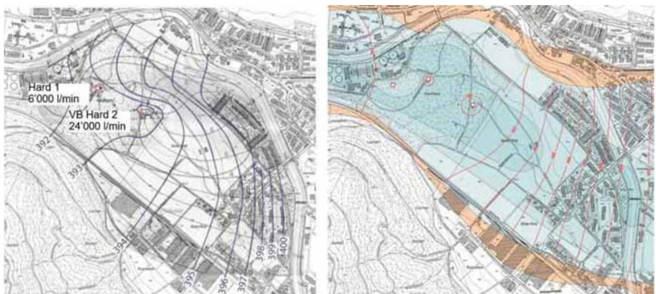
Figur 6: Vergleich Messung und Modell für Pumpversuch 1982 ( Q_{tot.} = 30'000 \text{ l/min} in Hard 1 + 2)
