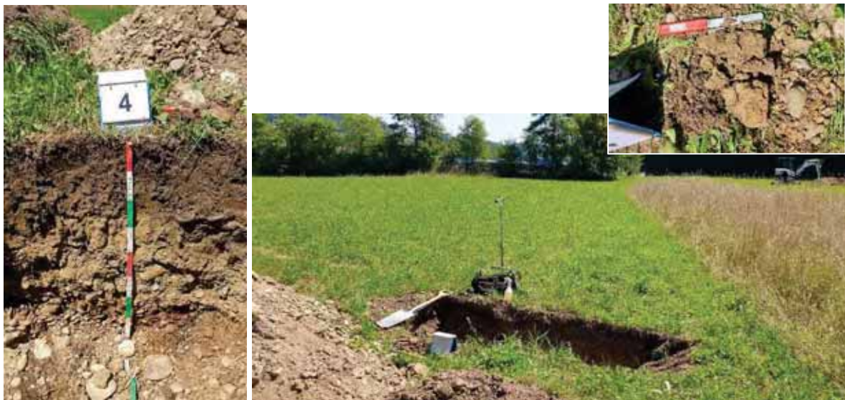
Foto 4: Profil Nr. 4 mit Profilwand (links), Gefüge pro Horizont (rechts oben) und Situation (rechts unten; Blick Richtung E); Aufnahme vom 6. Juli 2022.
