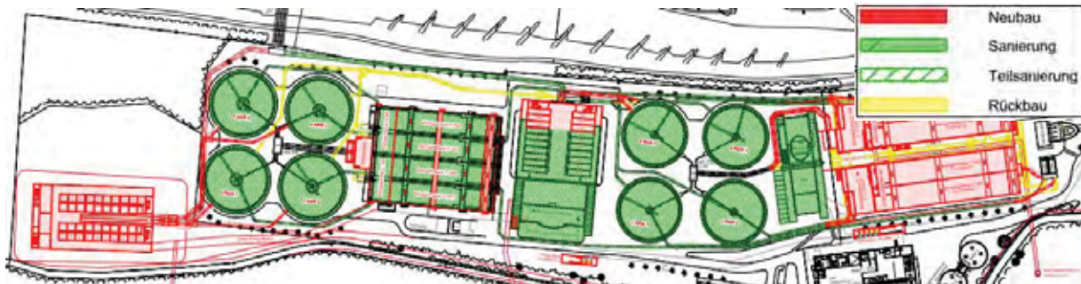
Abbildung 3 Situationsplan Variante A1 optimiert (Variante A1 mit gedrehter Anlage zur GAK-Filtration)
