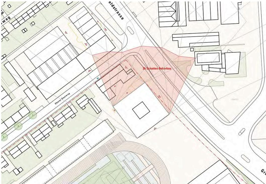
Abbildung 26: 3h-Schatten Ankerbau gemäss Richtprojekt (Galli Rudolf Architekten)
