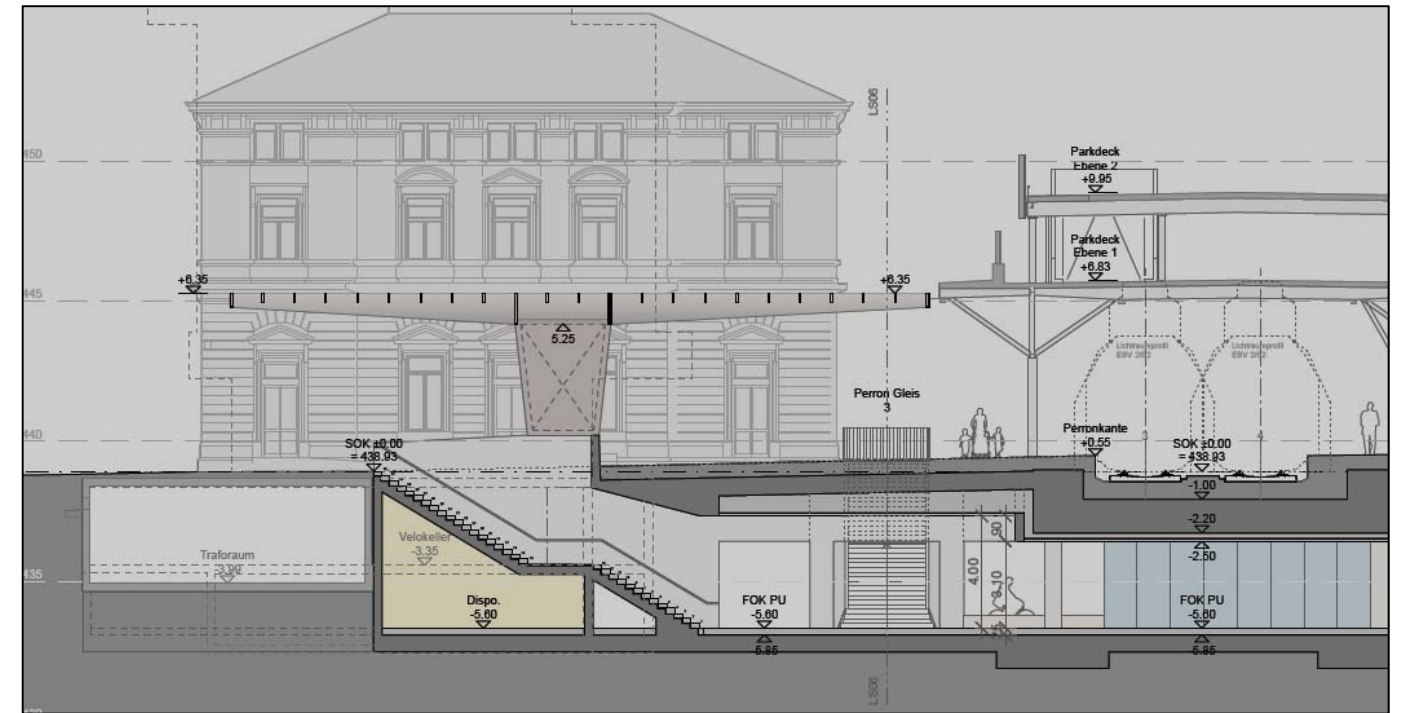
Querschnitt Modul 3 Kopfbau Bahnhofplatz mit neuer Überdachung
