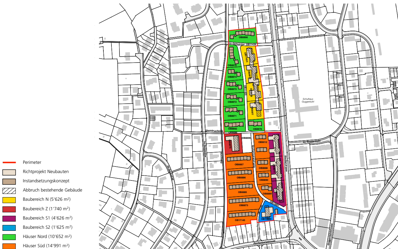
Abb. 34: Bezugsflächen (massgebliche Grundflächen) für die Baumassenberechnung
