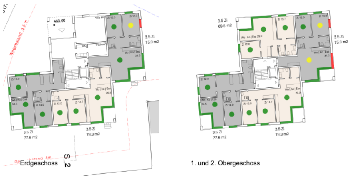
Abbildung 8: Grundrisse Baufeld S2 mit Lärmbeurteilung
